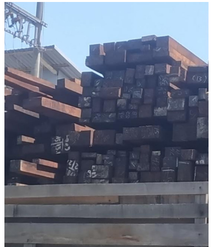
Gambar 27 Truk yang membawa kayu olahan gergajian masuk ke lokasi CV Almenta (atas), kayu olahan yang diterima CV Almenta dengan potongan yang tidak rata dan tidak seragam (bawah)
